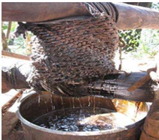
"Torcedera", prensa artesanal para extraer la resina
